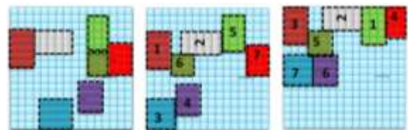
الف- قبل از مهاجرت ب- مهاجرت کار با استفاده از روش LLRC ج- مهاجرت کار با استفاده از روش HCM
