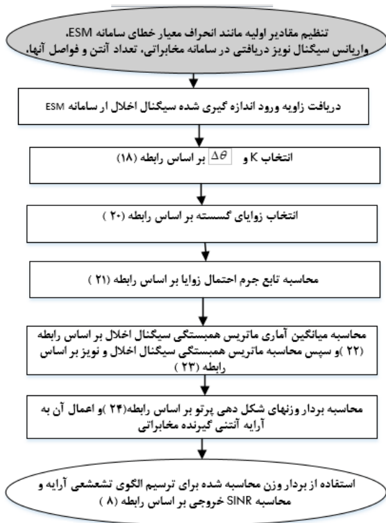
شکل (۴): بلوک دیاگرام روش پیشنهادی برای شکل‌دهی پرتو گیرنده مخابراتی
